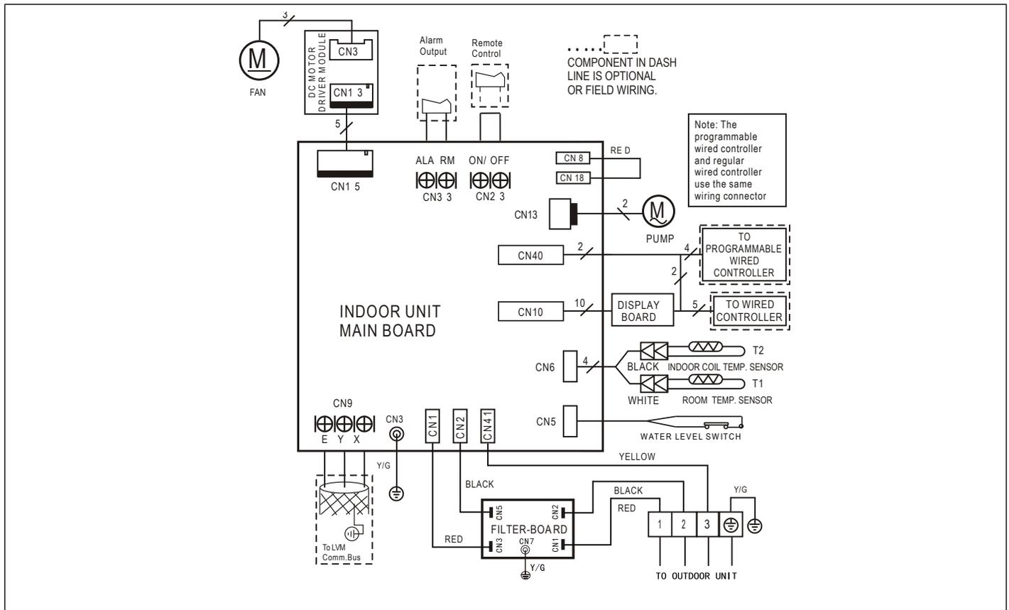
Figure 29. MMDA009S4-\*P, MMDA012S4-\*P, MMDA018S4-\*P Ducted Units Wiring Diagram
